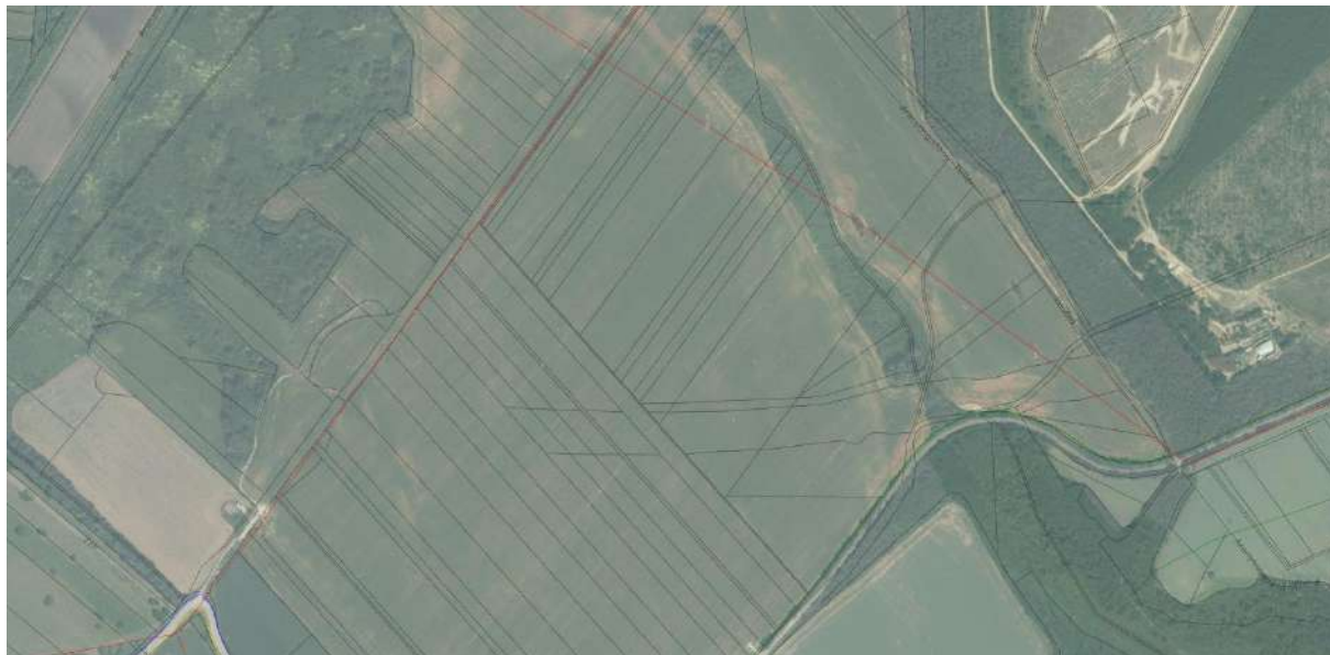
Az M60 Aranyosgadányt érintő közművezetékei - piros: 22 kV-os villamos vezeték, sárga: középnyomású szénhidrogén vezeték
